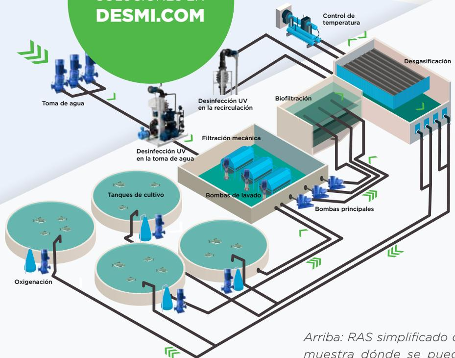
Arriba: RAS simplificado que muestra dónde se pueden utilizar las bombas y soluciones DESMI
