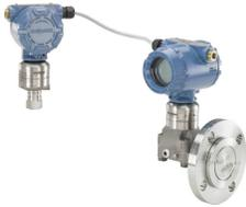
El sistema Rosemount 3051S ERS es una arquitectura HART® de 4-20 mA flexible de 2 hilos que calcula la presión diferencial (DP) de forma electrónica utilizando dos sensores de presión que se enlazan juntos con un cable eléctrico no patentado.
